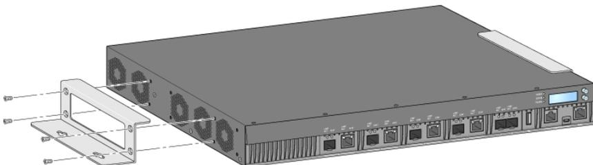
2. 장착 위치를 선택한 후 벽면에서 장착 구멍 위치를 표시합니다.
